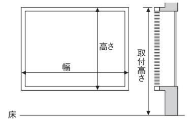
● カーテンボックスの内側に取り付ける場合 幅はボックスの内側寸法から10mm程度差し引いてください。高さはボックスの内側上部から測ってください。
