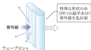
② 繊維自体に紫外線を反射する繊維を使用することで、透過を低減させる。
