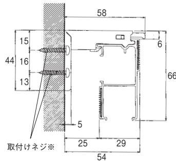
※取付けネジは下地位置の状況に応じて図のどちらかの位置に取付けてください。
