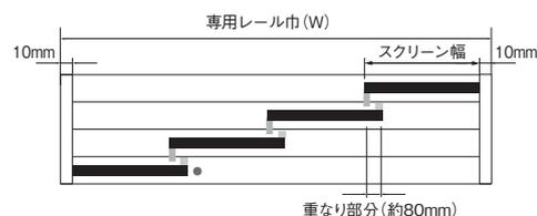
(例) 専用レール巾が2400mm、スクリーンの枚数が4枚とすると1枚のスクリーン巾は  $\frac{(2400-20) + 80 \times 3}{4} = 655\text{mm} \rightarrow 650\text{mm}$
