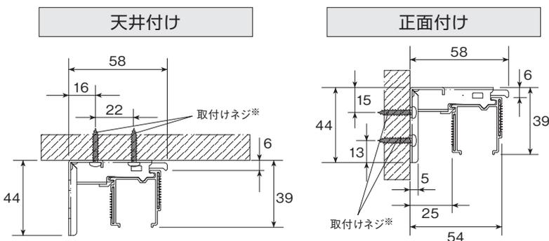
※取付けネジは下地位置の状況に応じて図のどちらかの位置に取付けてください。
