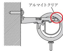
レールのアルマイトクリア加工面をリングランナーが走行。従来のリングランナーに比べ、約25%の操作力を低減し、43db程度の静かな走行音を実現。
