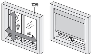
※操作方法により生地幅寸法は製品幅寸法より短くなりますのでご注意ください。
