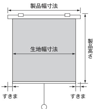
●天井付け(窓枠内に取付ける場合)
