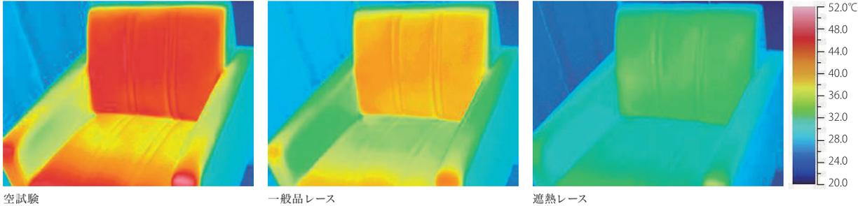
試験室に提出試料(1.5倍ヒダ)を取り付け、窓の外側から室内に向けて投光機による照射を行う。
