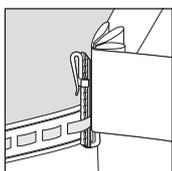
カーテンのヒダにフックを差し込みます。カーテンをレールに取り付けた後に左右の位置を整え、専用のサイドクリップで固定します。
