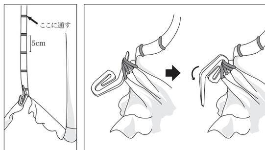
生地裏面の下端についているフックを2つおきにすくいあげるようにドレープを通し、お好みの高さでフックを回して固定します。
