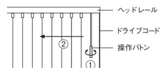
**注意** 故障の原因になりますので、ルーバーの開閉操作は必ずルーバーがヘッドレールに対して直角の状態で行なってください。
