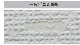
表面が破けて裏打ち紙が見える
