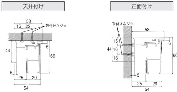
※取付けネジは下地位置の状況に応じて図のどちらかの位置に取付けてください。
