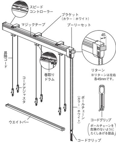
取付寸法図(ダブルシェードコード式)(単位:mm)
