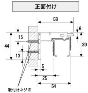
※取付けネジは下地位置の状況に応じて図のどちらかの位置に取付けてください。
