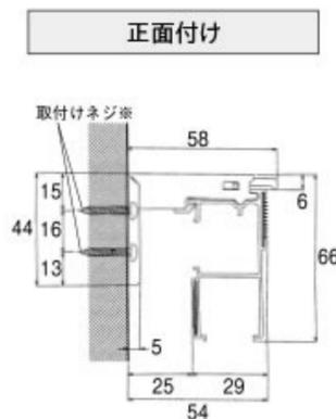
※取付けネジは下地位置の状況に応じて図のどちらかの位置に取付けてください。
