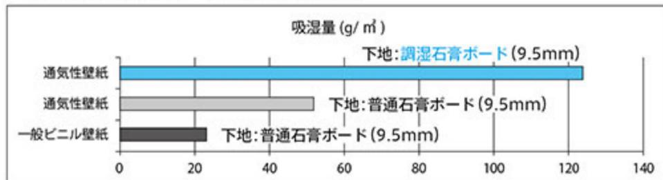
通気性壁紙を調湿石膏ボード下地に施工すると、調湿効果が飛躍的にアップします。
