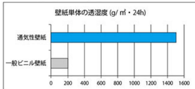
24時間に壁紙を通り抜けた水蒸気量を測定したもので、**数値が大きいほど透湿性が高い**ことを示します。
