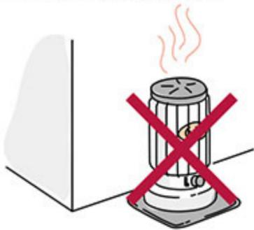
ストーブなど暖房器具の熱風が直接壁紙に当たらないようにしてください。また、キッチンのレンジやダウンライトのすぐ近くなど、高温になる場所への使用は避けてください。熱により壁紙が変形、変色することがあります。
