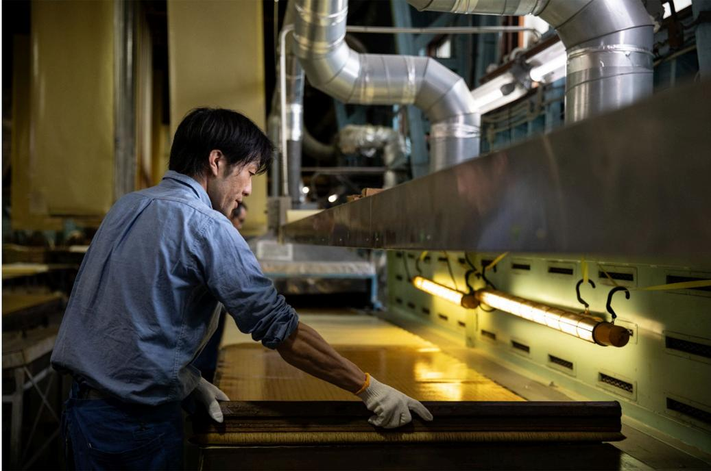
箔の変色と腐食を防ぐ接着・コーティング工程。
