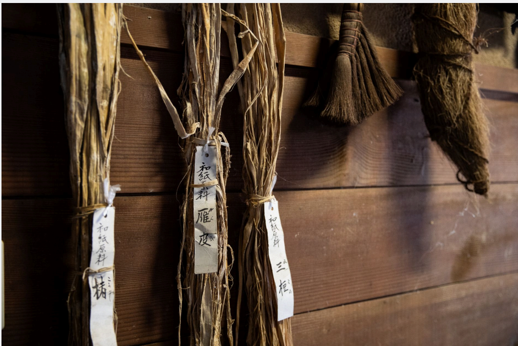
和紙の原料となる楮や三椏、雁皮の木の皮。 煮出す前、しばらく水に浸すことで柔らかくします。
