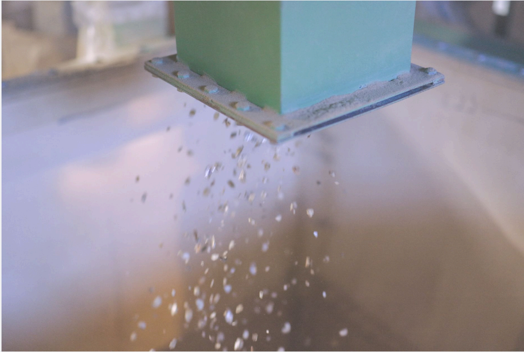
富士工業では蛭石を再粉砕し、大きさに分けて選別。 デザインに合わせてサイズを使い分けます。
