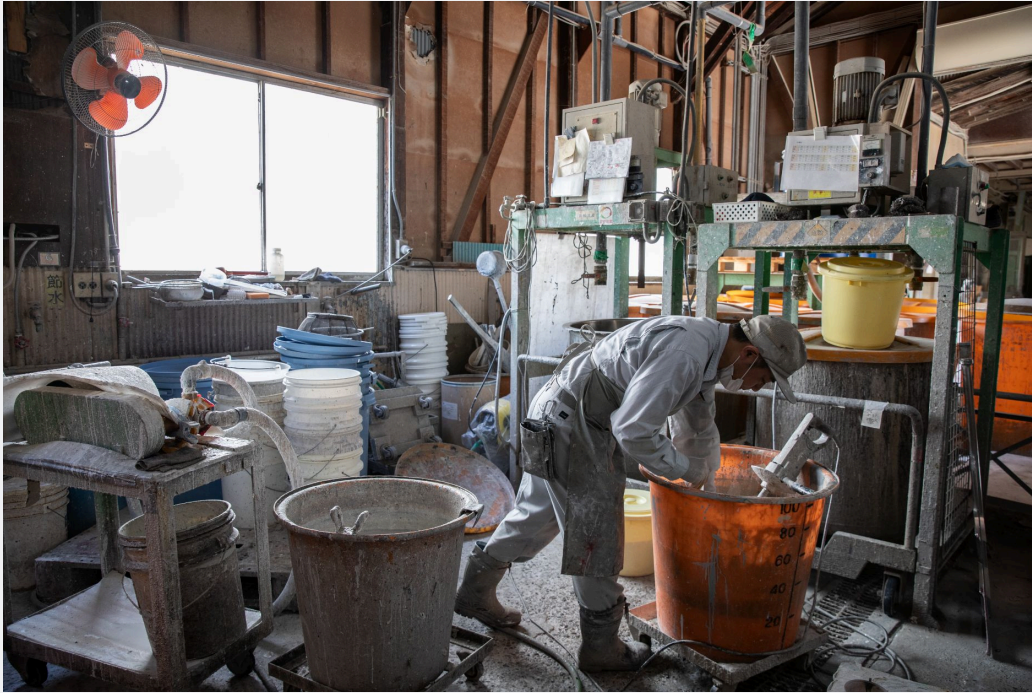
トップコートの調合は、非常に繊細な工程。 素材の個性に合わせて、配合を変える必要があります。
