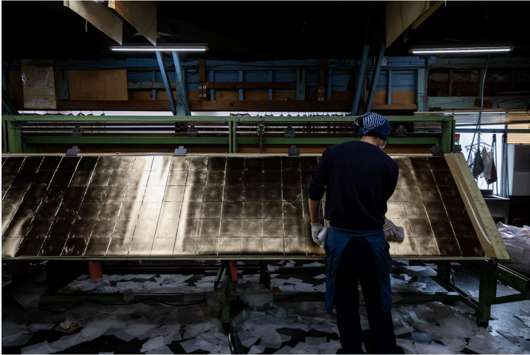
箔押しの後、専用の道具で余分な箔を取り除きます。 力加減が難しく、熟練の技が必要だとか。
