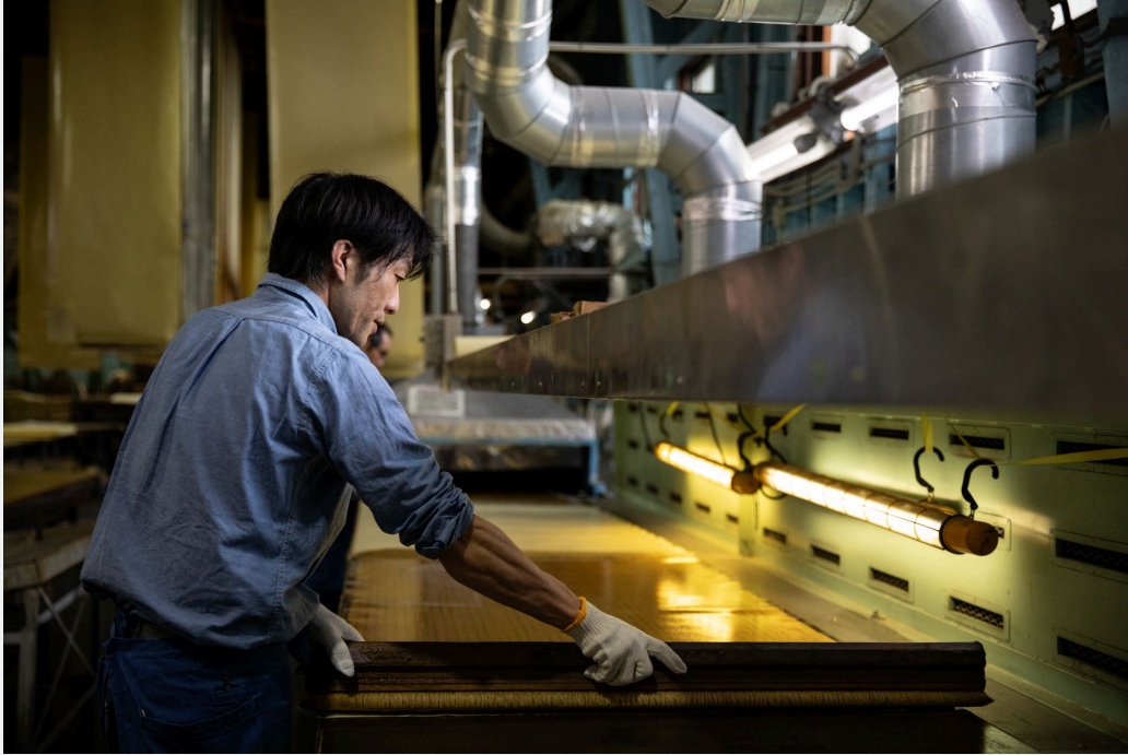
箔の変色と腐食を防ぐ接着・コーティング工程。 箔をきれいな状態に保つのも技術が必要です。
