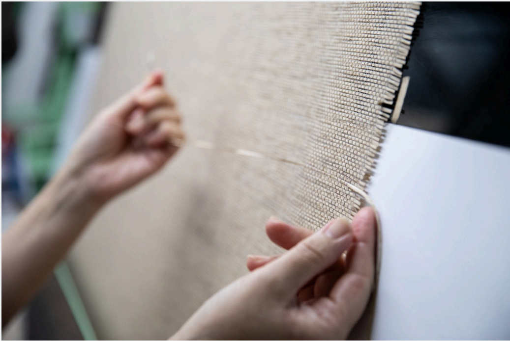
検反機を使いながら、製織された生地を確認。 同時に不要物を取り除いたり、補修したりします。
