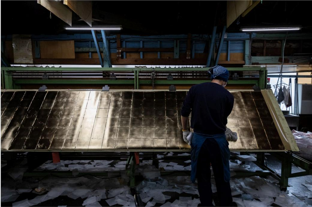
箔押しの後、専用の道具で余分な箔を取り除きます。
