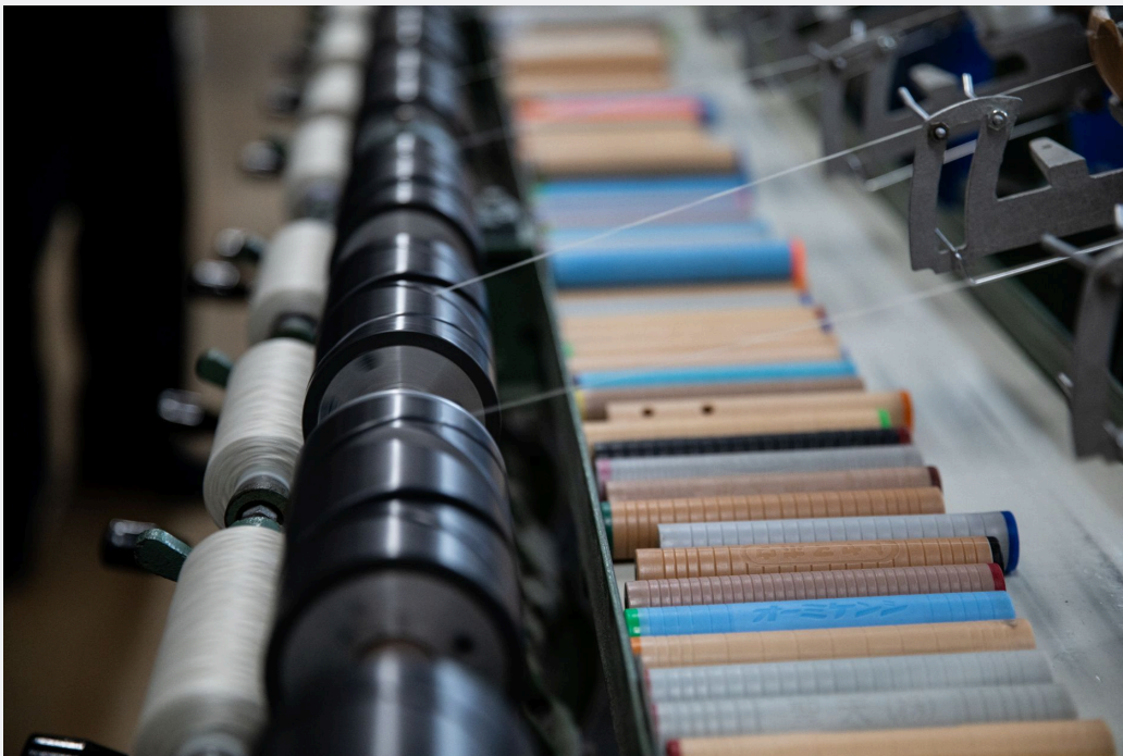
経糸用の糸巻き工程。 さまざまな製糸工場から譲り受けた木管を一つひとつ大切に使用している。
