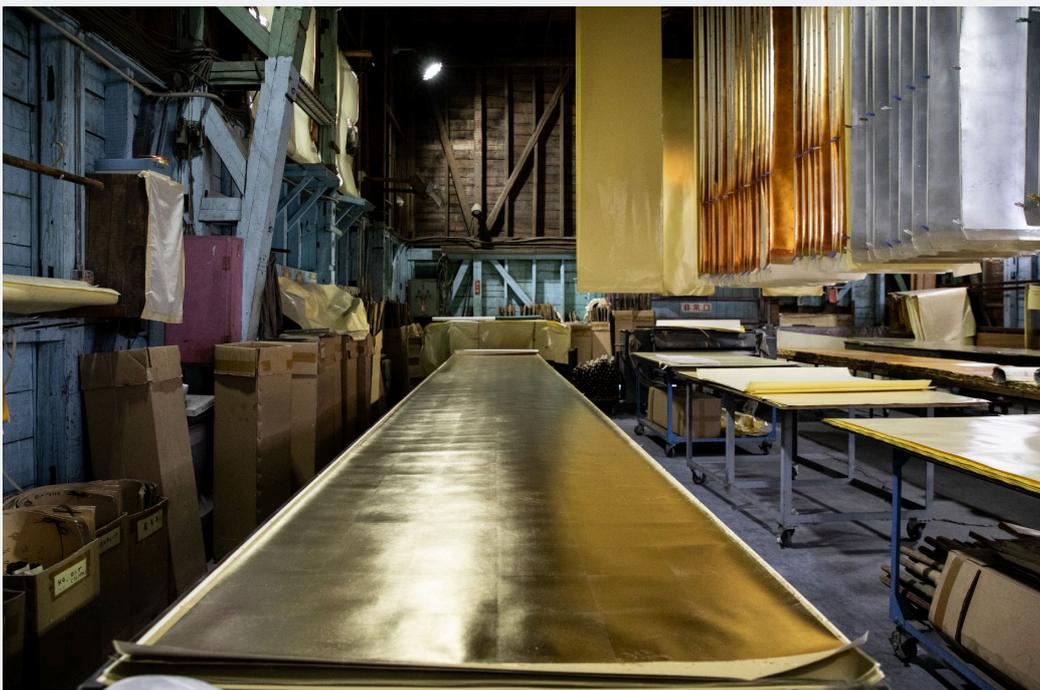
紙と箔の密着性を向上させるため、約2週間吊るした状態で寝かせます。
