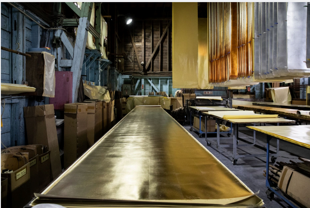
紙と箔の密着性を向上させるため、約2週間吊るした状態で寝かせます。 美しい金の光が工場内を染め上げます。
