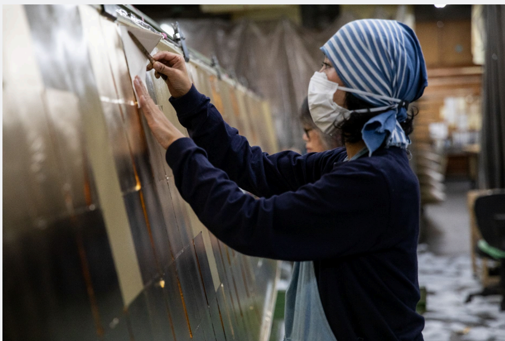
洋金箔の箔押し工程。 7.4メートルの紙に、複数人で位置を変えながら貼り付けていきます。
