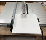
昇降盤での切断
